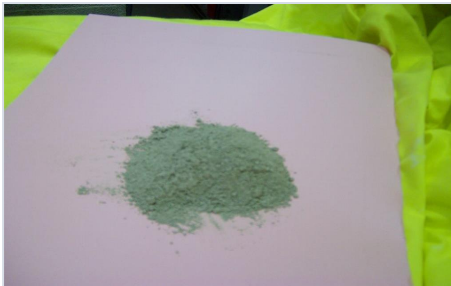
الصورة رقم (3) شكل المنتج الجانبي من استغلال صخور الفونولايت الجدول رقم (3) الخصائص الفيزيائية المنتج الجانبي من استغلال صخور الفونولايت
