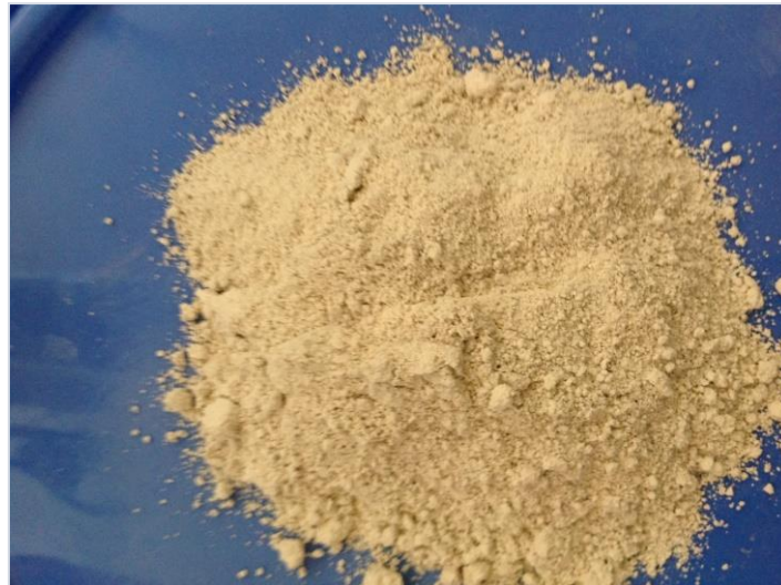
الصورة رقم (2) توضح شكل الفلسبار المحلي بعد الطحن
